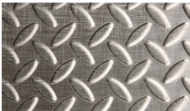
Tränenblech geprägt u. kreuzgeschliffen
