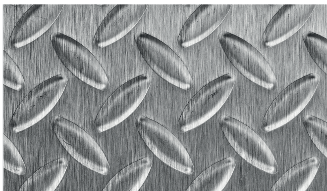
Tränenblech geprägt und geschliffen
